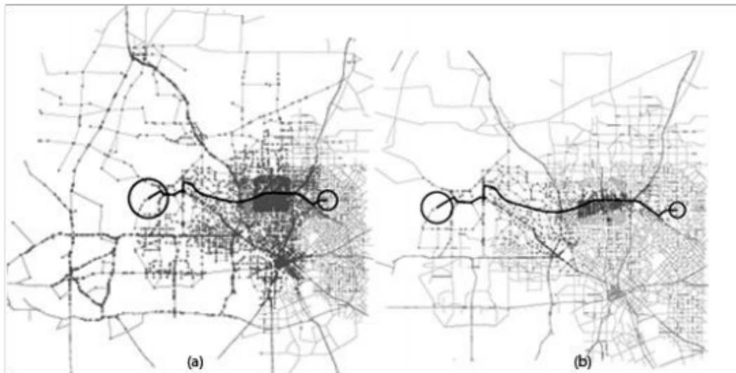
Abbildung 4.9: (a) Dijkstra's-Suche (b) A^* -Suche auf einem Straßennetz vom Dallas Ft-Worth Stadtgebiet 5
